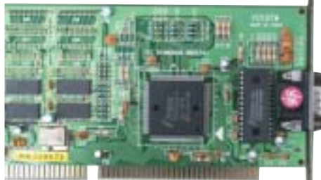
FIGURA 2. PE ACEASTĂ VECHE PLACĂ ISA pot fi observate mai multe elemente de identificare, care vă pot ajuta: țara de origine, modelul, tipul cipsetului video, identificatorul FCC-ID și numărul de serie.
